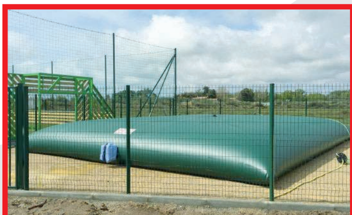
120 m3 - Hors sol - Prise directe sur le flanc
